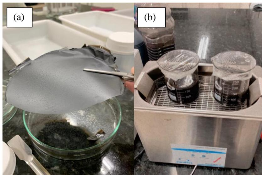
Figura 1 – (a) Película de óxido de grafeno sintetizado no laboratório da universidade para o presente trabalho, (b) Processo de dispersão do óxido de grafeno utilizando equipamento de ultrassom.
