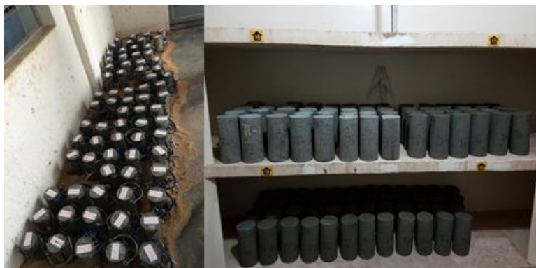
Figura 4 – Corpos-de-prova de concreto moldados e em processo de cura em câmara úmida
